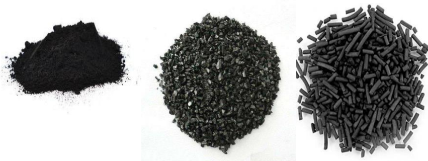
Slika 3. Aktivni ugljen u obliku: a) praha, b) granula, c) peleta (Medverec Knežević, 2019.)
