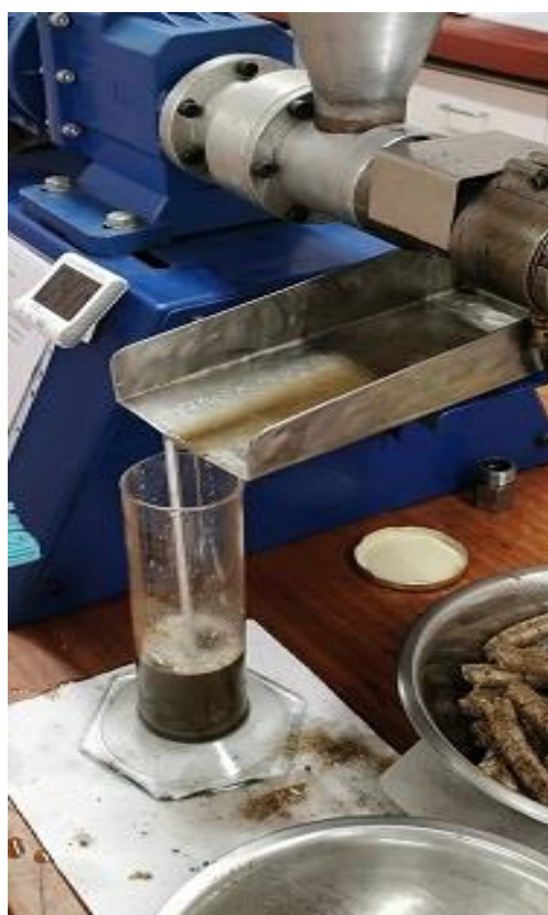
Slika 9 Izlaz i prikupljanje sirovog ulja
