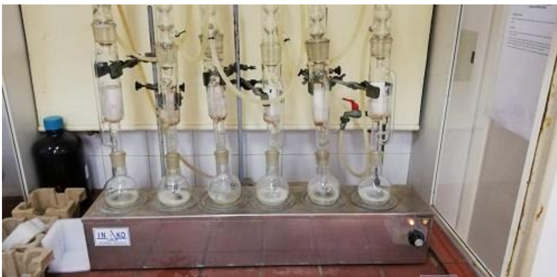
Slika 14 Aparatura za ekstrakciju ulja po Soxhlet-u
