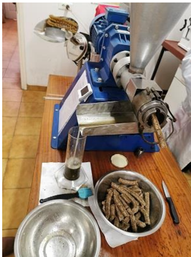
Slika 8 Laboratorijska kontinuirana pužna preša tijekom prešanja
