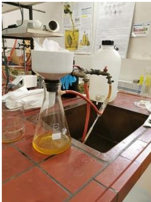
Slika 13 Vakuum filtracija sirovog ulja sjemenki sikavice
