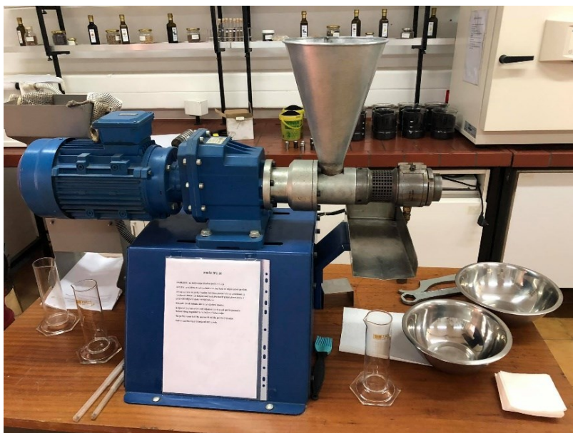
Slika 8 Laboratorijska kontinuirana pužna preša
