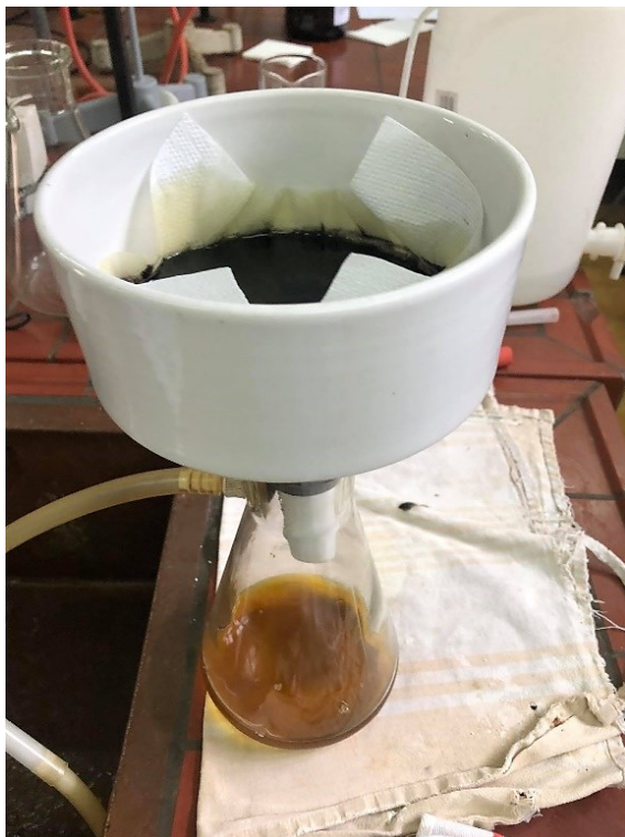
Slika 12 Vakuum filtracija sirovog ulja crnog kima
