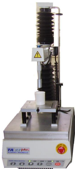
Slika 12 Uređaj Texture analyzer TA-XT plus
