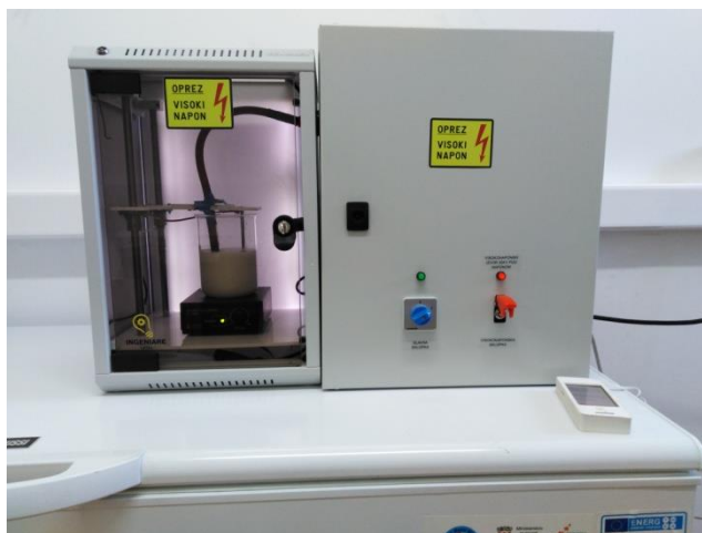
Slika 10 Uređaj za visokonaponsko električno pražnjenje
