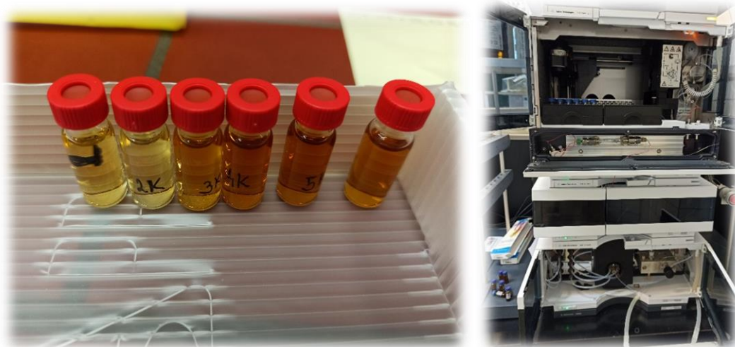
Slika 17: Prikaz uzorka i HPLC uređaja (Izvor: autor)
