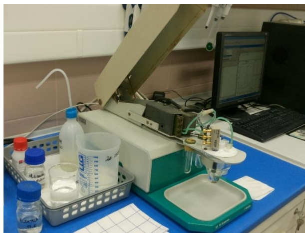
Slika 5 Uređaj za voltametrijsko određivanje arsena u vodi Computrace 757 VA, Metrohm
