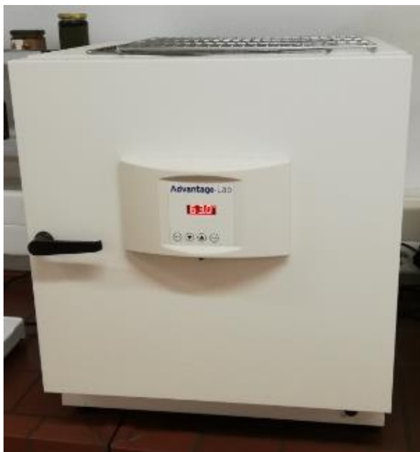
Slika 23. Sušionik zagrijan na 63 °C za provedbu Oven testa
