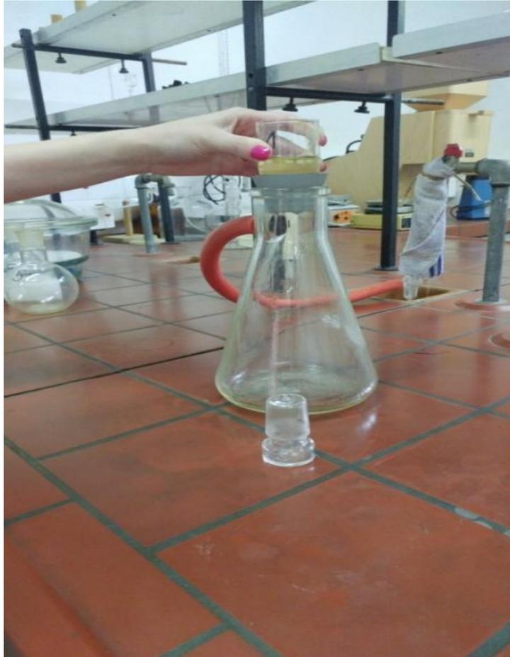
**Slika 22** Primjena vakuum filtracije
