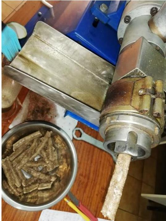
**Slika 16** Prešanje laboratorijskom pužnom prešom
