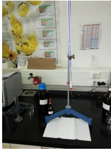
Slika 20 Aparatura i reagensi potrebni za određivanje peroksidnog broja
