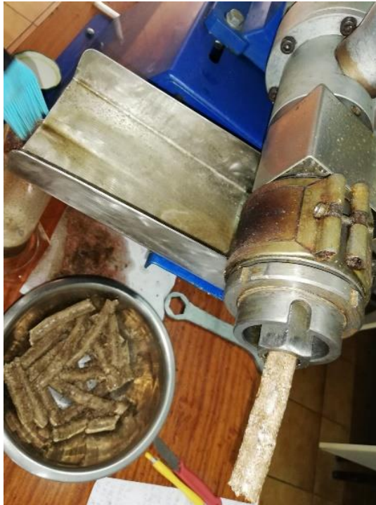
Slika 16 Prešanje laboratorijskom pužnom prešom
