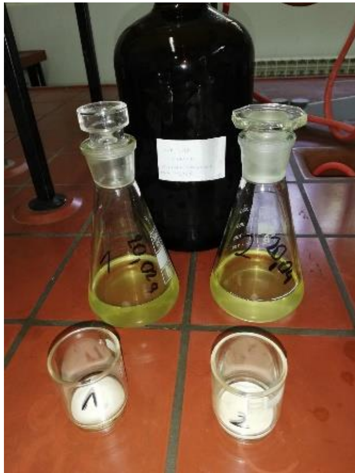
Slika 21 Određivanje netopljivih nečistoća u ulju
