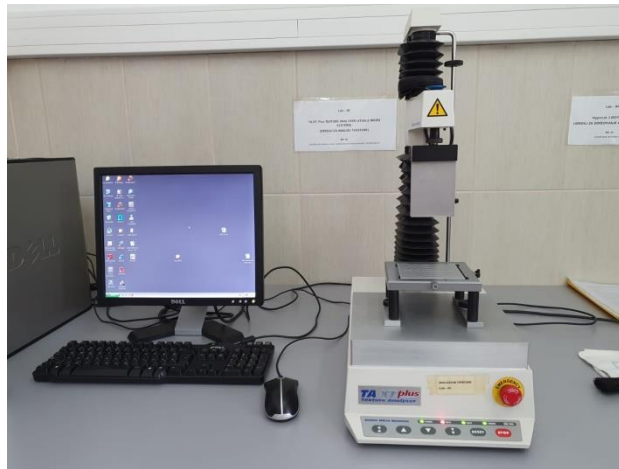
Slika 9 Analizator teksture TA.XT2 Plus, Stable Micro System, Velika Britanija
