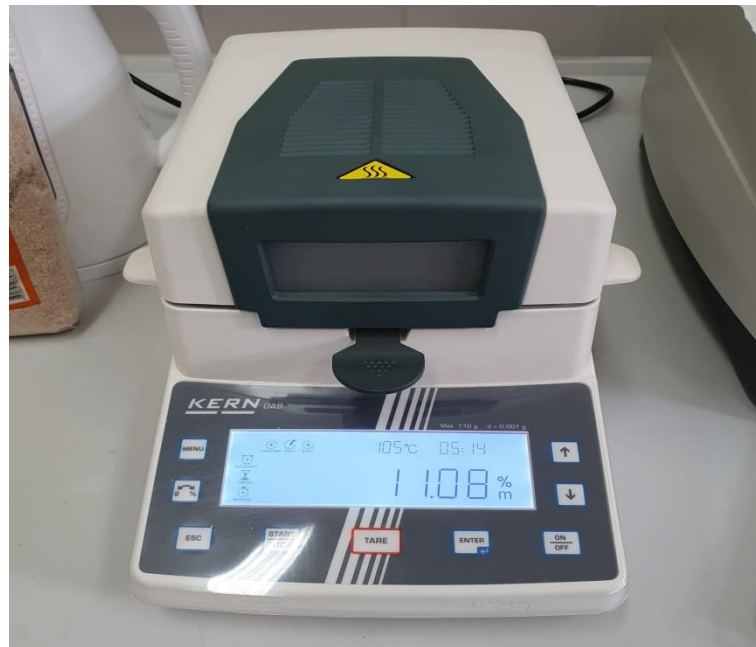
Slika 7 Uređaj za određivanje vlažnosti materijala KERN DAB
