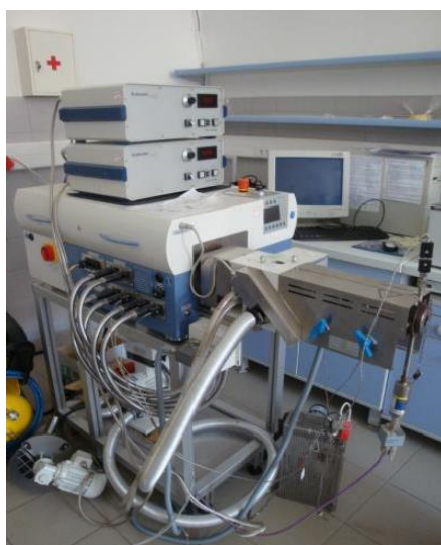
Slika 10 Laboratorijski jednapužni ekstruder Brabender 19/20 DN (Jozinović, 2015.)
