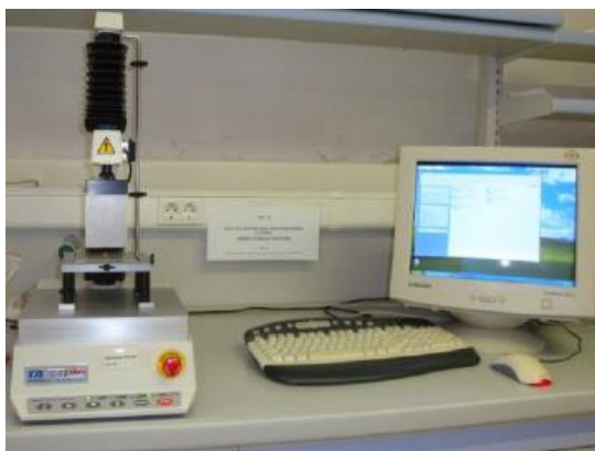
Slika 11 Analizator teksture TA.XT2 Plus, Stable Micro System (Jozinović, 2015.).
