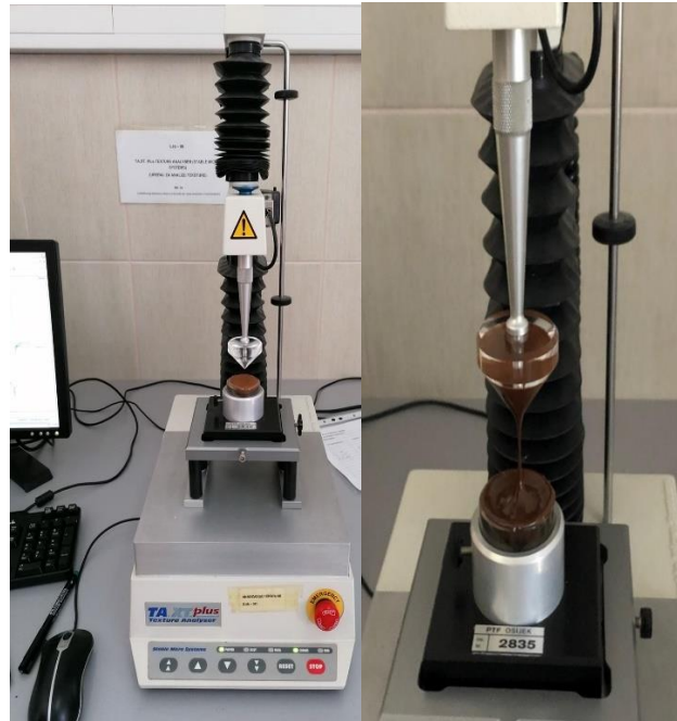
Slika 21 Prikaz prodiranja nastavka konusnog oblika za određivanje teksture
