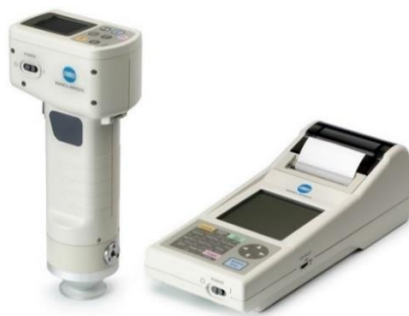
Slika 19 Kromametar Konica Minolta CR-400 (web izvor 16)
