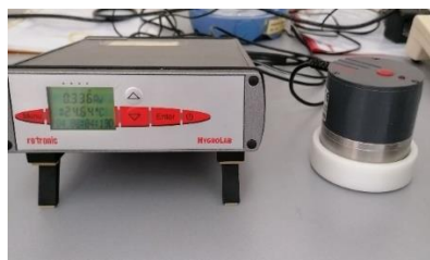
Slika 22 Uređaj za mjerenje aktiviteta vode (HygroLab 3, Rotronic)
