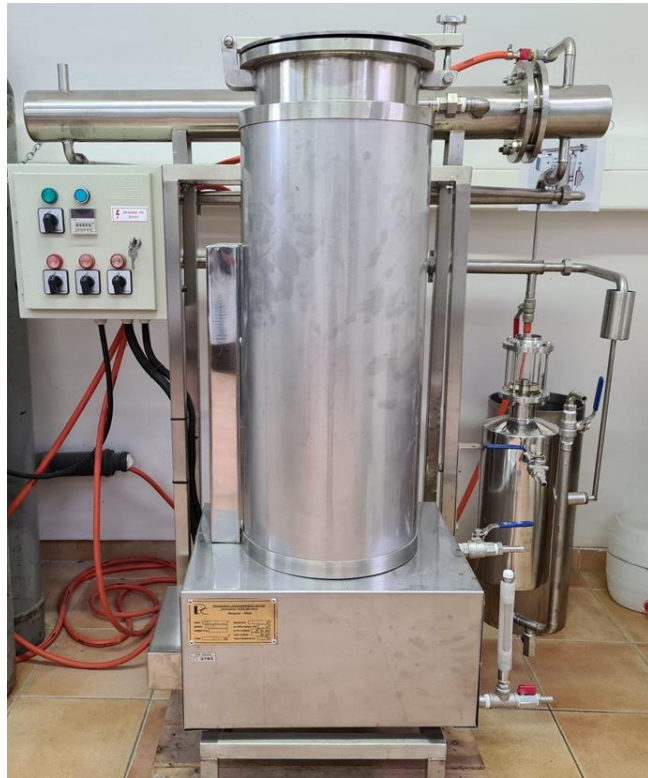
Slika 5 Pilot postrojenje za destilaciju (Izvor: Autor)
