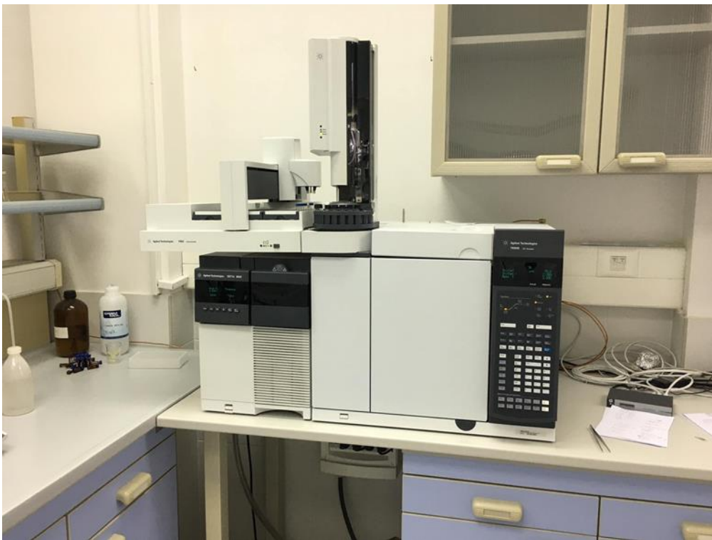
Slika 9 Uređaj za GC-MS (Izvor: Autor)
