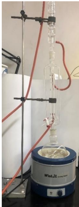
Slika 4 Aparatura po Clevenger-u (Izvor: Autor)
