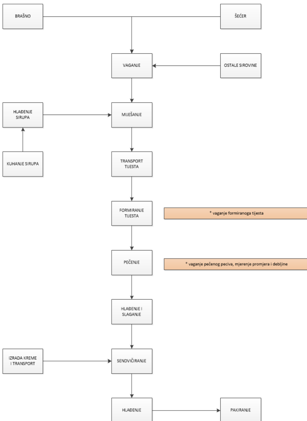
Slika 1 Shematski prikaz industrijske proizvodnje keksa
