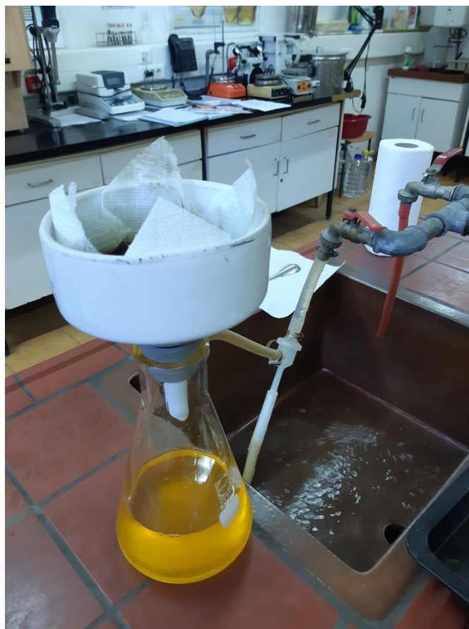
Slika 7 Vakum filtracija sirovog lanenog ulja
