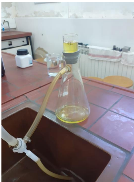
Slika 12 Vakuum filtracija organskim otapalom
