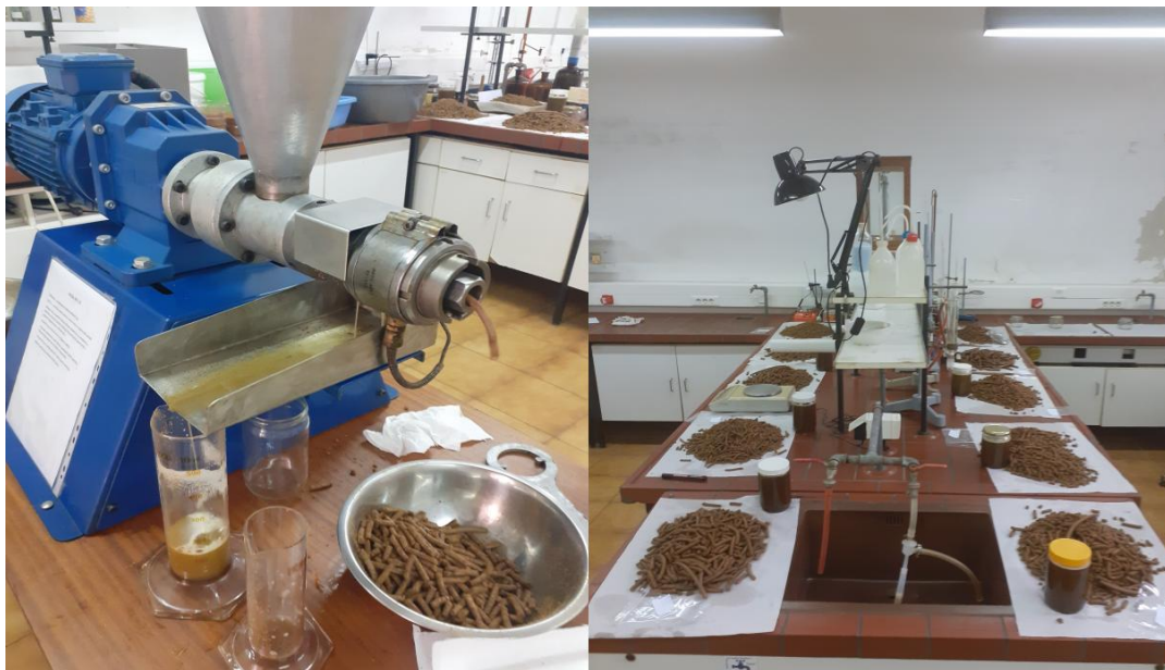
Slika 20 Hladno prešanje sjemenki podlanka te nastalo sirovo ulje i pogače za pojedine procesne parametre
