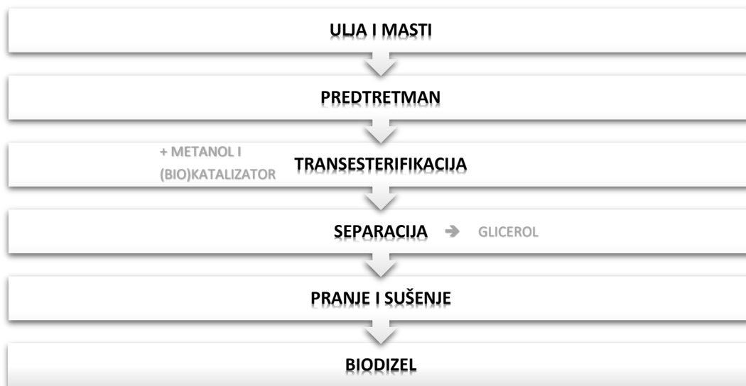
Slika 4 Opći prikaz procesa sinteze biodizela
