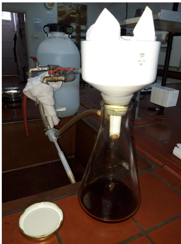
Slika 14 Vakuum filtracija sirovog ulja
