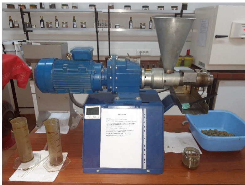
Slika 8 Kontinuirana pužna preša proizvođač ElektroMotor-Šimon d.o.o.
