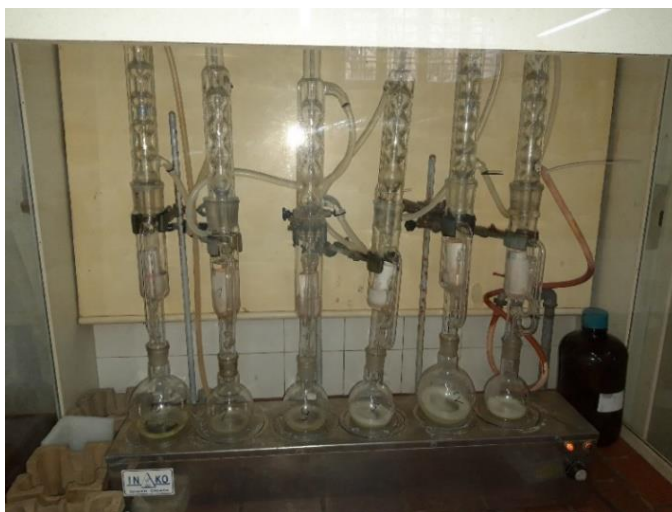
Slika 15 Ekstrakcija ulja po Soxhlet-u
