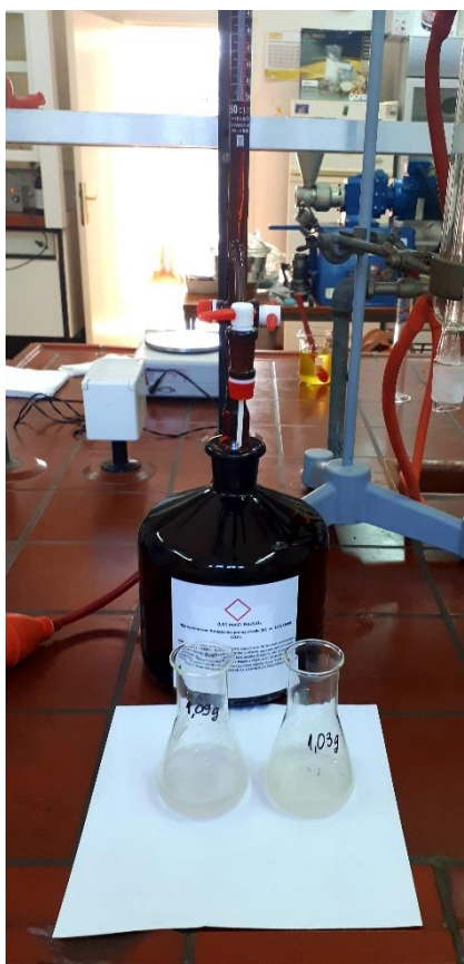
Slika 28 Određivanje peroksidnog broja
