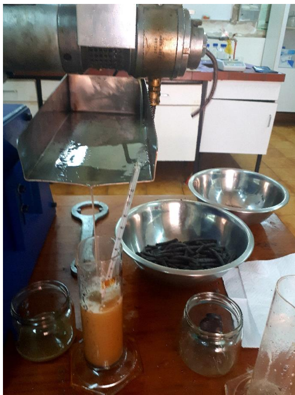
Slika 19 Prešanje laboratorijskom pužnom prešom i izlaz sirovog ulja i pogače
