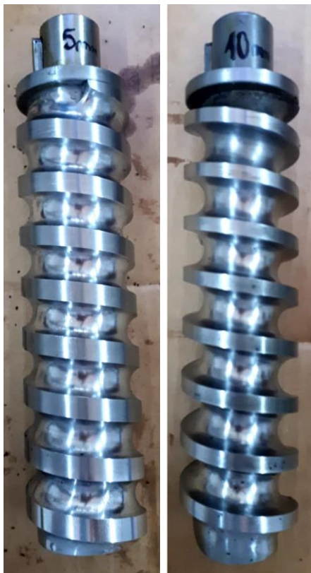
Slika 18 Pužnice s dvije različite dubine navoja (5 mm i 10 mm) korištene kod prešanja
