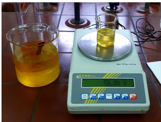
Slika 30 Priprema uzorka ulja za ispitivanje oksidacijske stabilnosti
