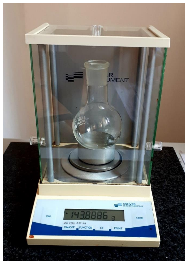
Slika 25 Vaganje tikvice sa nekoliko kuglica za vrenje na analitičkoj vagi
