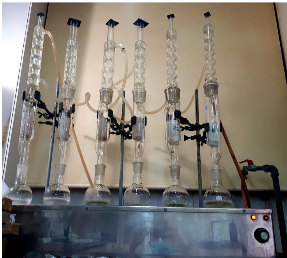
Slika 26 Određivanje ulja po Soxhlet-u
