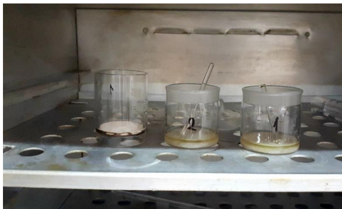
Slika 29 Sušenje uzorka ulja u sušioniku 2 sata
