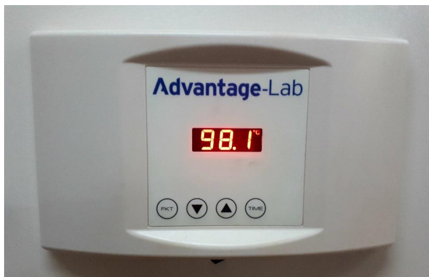
Slika 33 Primjena sušionika za provedbu testa oksidacijske stabilnosti na 98 °C
