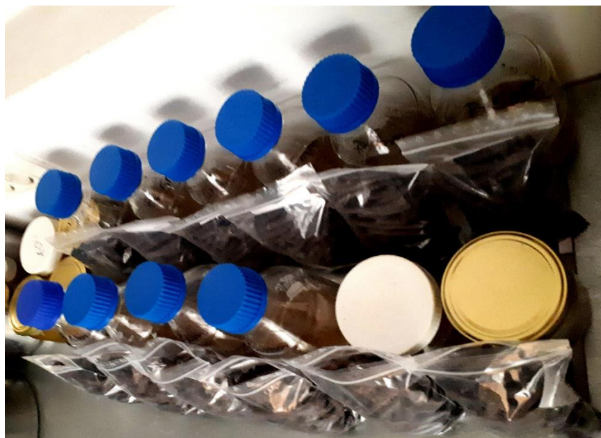
Slika 21 Taloženje krupnih čestica u sirovom ulju maka tijekom 14 dana na sobnoj temperaturi u tamnom prostoru
