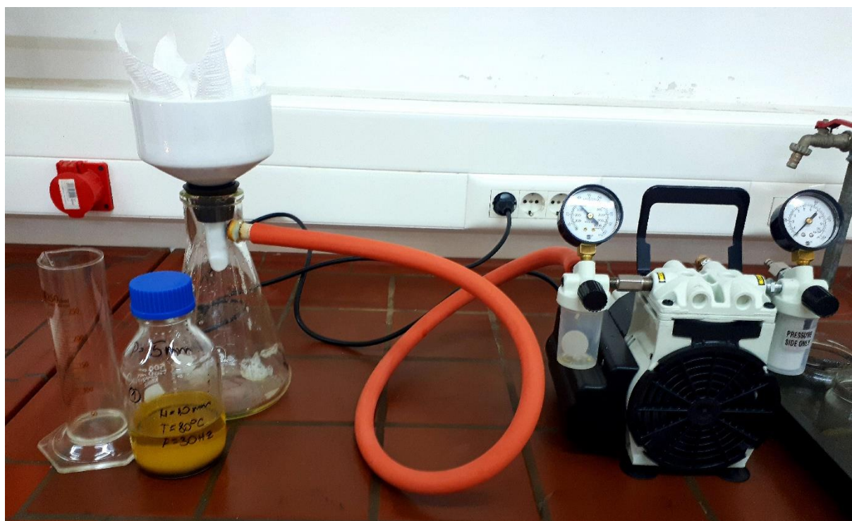
Slika 22 Uklanjanje sitnih krutih čestica iz sirovog makovog ulja s vakuum filtracijom
