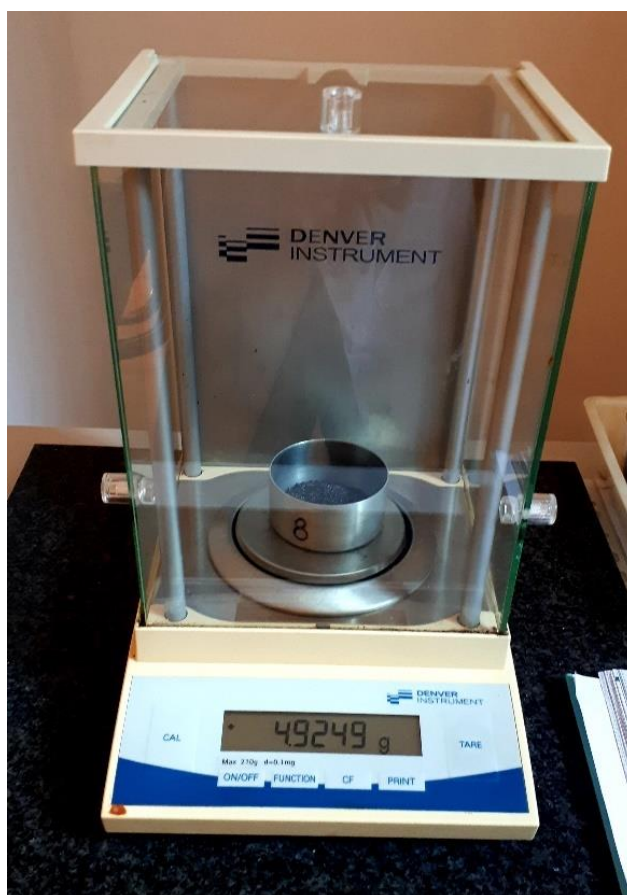
Slika 27 Vaganje uzorka sjemenke na analitičkoj vagi
