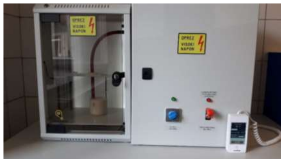
Slika 7 Uređaj za generiranje plazme (SFE Systems Ltd.)
