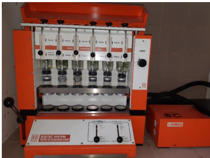
Slika 12 Soxtec uređaj za određivanje udjela ulja
