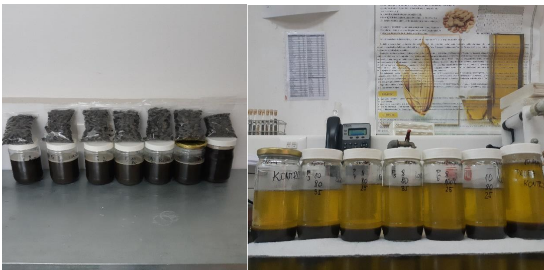
Slika 10 Sirovo ulje prije i nakon sedimentacije
