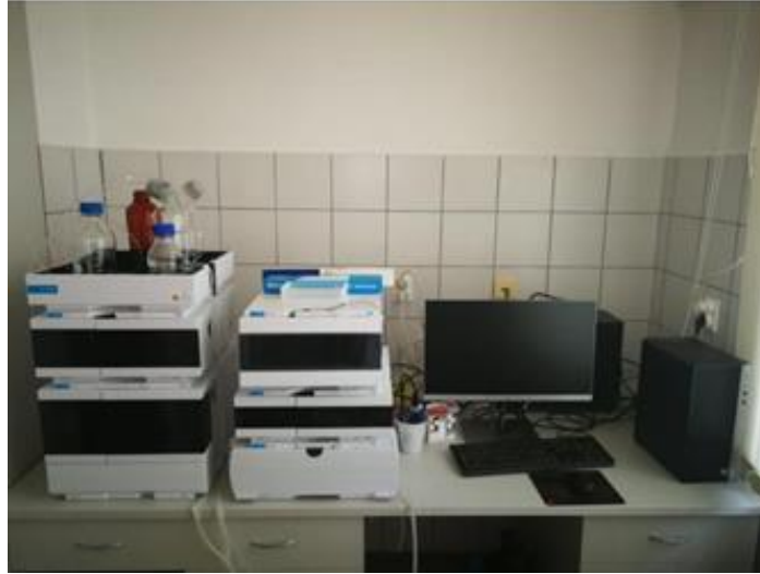
Slika 16 HPLC sustav korišten za identifikaciju i kvantifikaciju pigmenata u ekstraktima makroalgi (Izvor: autor)
