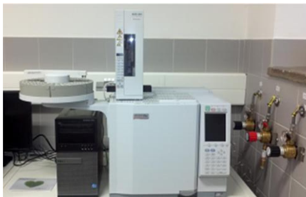
Slika 15 GC-FID sustav korišten za identifikaciju i kvantifikaciju masnih kiselina u makroalgama (Izvor: autor)
