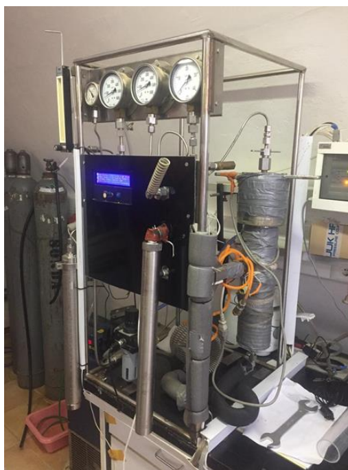
Slika 5 Uređaj za superkritičnu CO 2 ekstrakciju (Izvor: autor)
