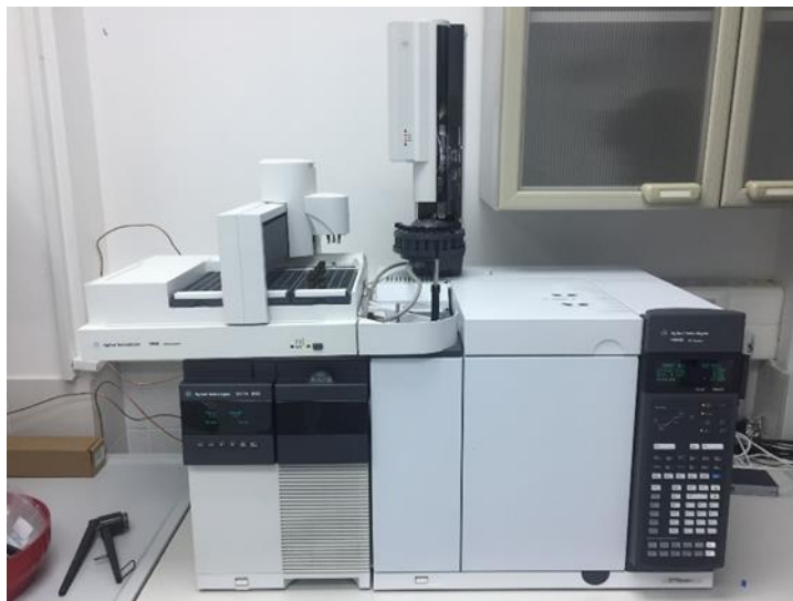
Slika 11 Uređaj za plinsku kromatografiju Agilent Technologies 7890B s masenim detektorom Agilent Technologies 5977A (Izvor: autor)
