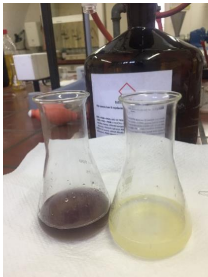
Slika 17 Određivanje Pbr (promjena boje prilikom titracije)
