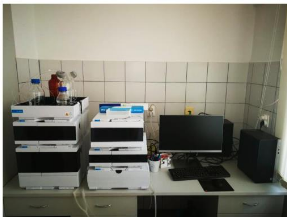
Slika 13. HPLC sustav Agilent 1260 Infinity II (Katalog opreme Prehrambeno-tehnološkog fakulteta Osijek, 2021)
