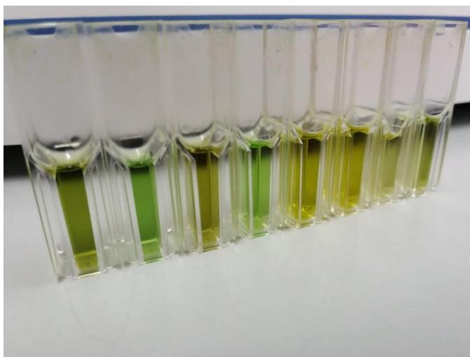
**Slika 14.** UAE ekstrakti makroalge *C. bursa* u kivetama za spektrofotometrijsko mjerjenje (izvor:autor)
