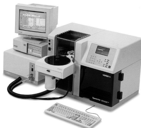
Slika 9. Uređaj za atomsku apsorpcijsku spektrometriju i određivanje koncentracije ukupnog željeza i mangana
