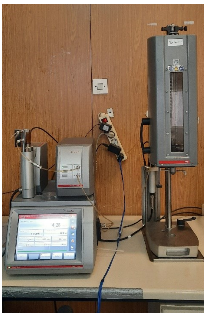
Slika 8 Analizator piva DMA 4500 M (vlastita arhiva)
