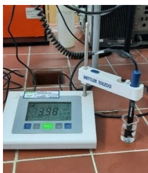
Slika 10 pH metar FiveEasy (vlastita arhiva)
