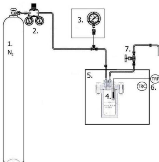
**Slika 9.** Procesna shema ekstraktora sa supkritičnom vodom.
