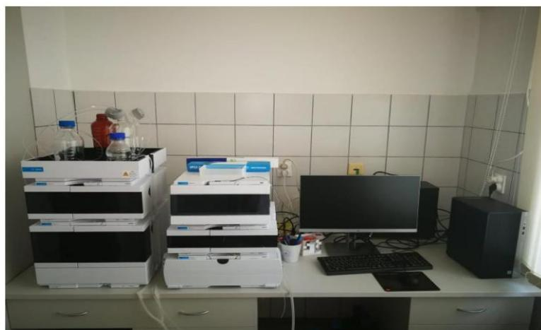
**Slika 13.** HPLC sustav Agilent 1260 Infinity II (Katalog opreme Prehrambeno-tehnološkog fakulteta Osijek, 2021)
