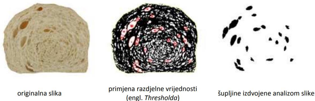
Slika 8. Postupak izdvajanja šupljina računalnom analizom slike
