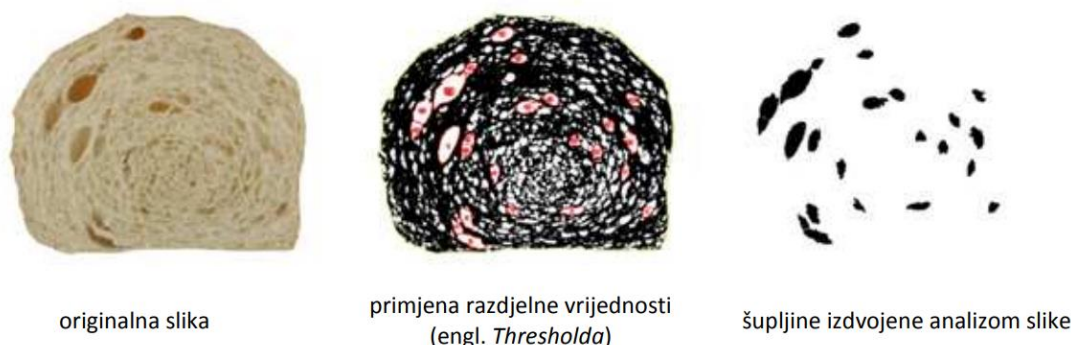
Slika 8. Postupak izdvajanja šupljina računalnom analizom slike
