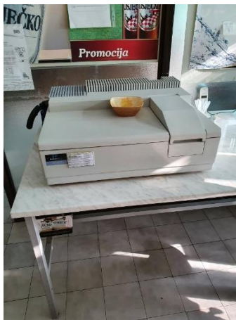
Slika 15 Spektrofotometar Lambda 25 proizvođača Perkin Elmer
