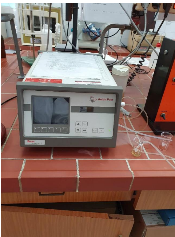
Slika 20 Beer Analyzer 2 proizvođača Anton Paar
