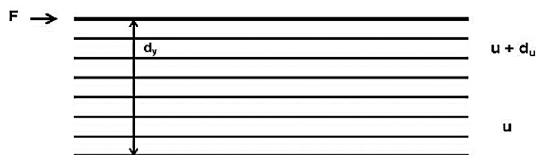
Slika 11 Prikaz viskoznog ponašanja tekućine (Lovrić, 2003)
