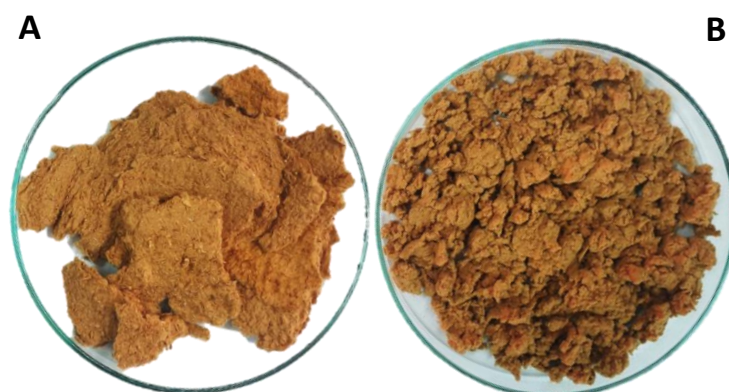
Slika 3 . Inaktivna biomasa gljive F. pinicola nakon filtracije kao filtracijska pogača (A) i nakon mljevenja (B).
