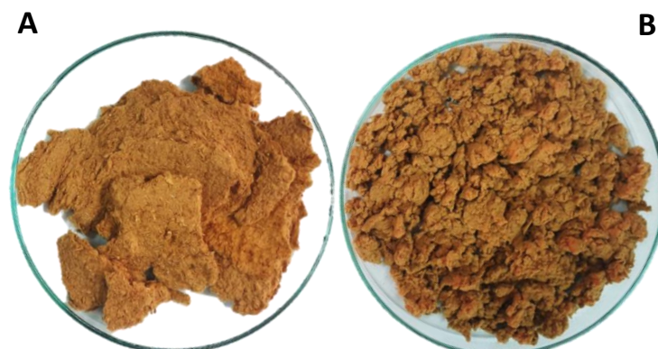
Slika 3 . Inaktivna biomasa gljive F. pinicola nakon filtracije kao filtracijska pogača (A) i nakon mljevenja (B).
