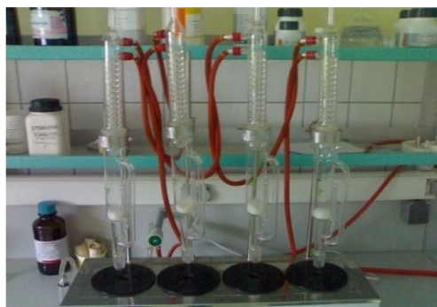
Slika 14 Aparatura za ekstrakciju masti po Soxhletu (Jozinović, 2015)
