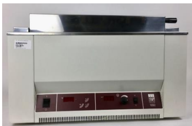
Slika 15 Vodena kupelj s treskalicom GFL 1092 ( https://www.wotol.com/product/gfl-1092-shaking-water-bath/2148652 ) (1. 4. 2022.)
