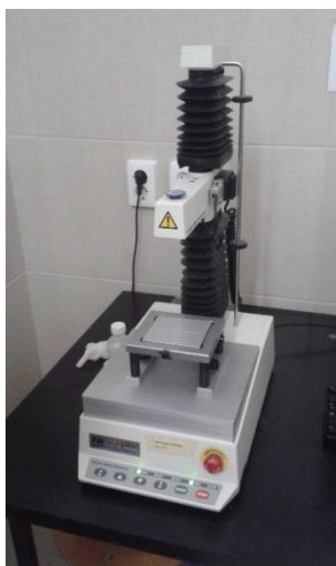
Slika 9 Analizator teksture TA.XT2 Plus, Stable Micro System
