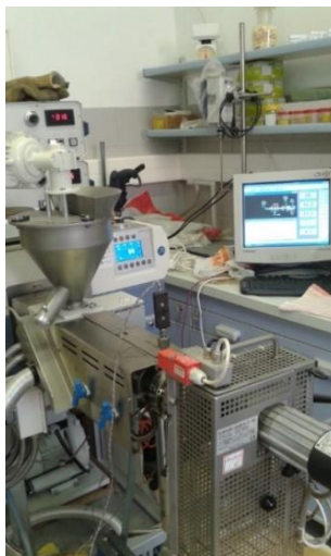
Slika 8 Laboratorijski jednopužni ekstruder Brabender 19/20 DN
