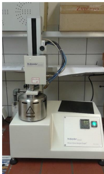
Slika 11 Brabenderov Mikro visko-amilograf
