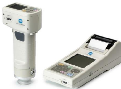
Slika 10 Kromametar Konica Minolta CR-400 (Jozinović, 2015)
