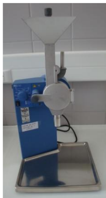
Slika 7 Laboratorijski mlin IKA MF10 (Jozinović, 2015)
