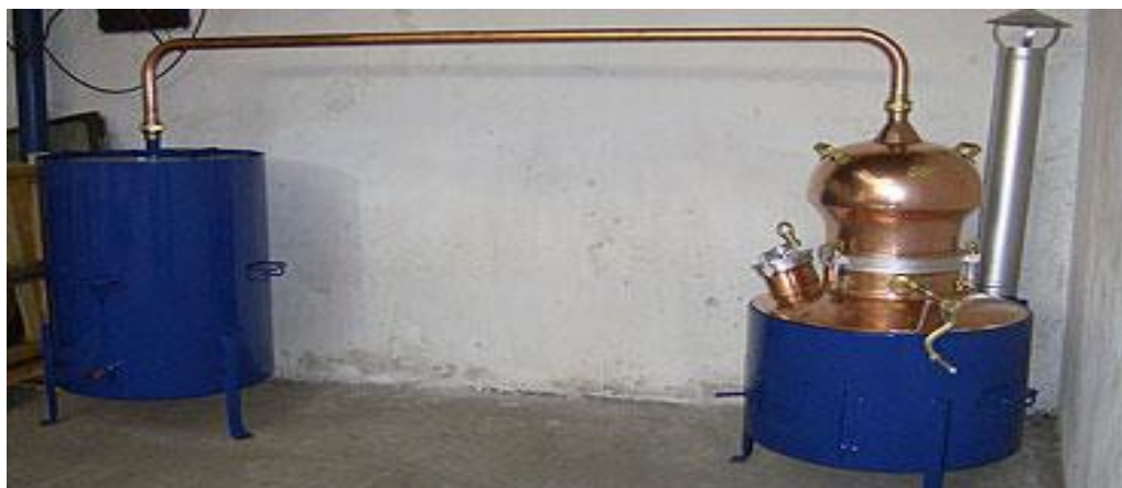
Slika 3 Tradicionalni uređaj za destilaciju, Alambik kazan
