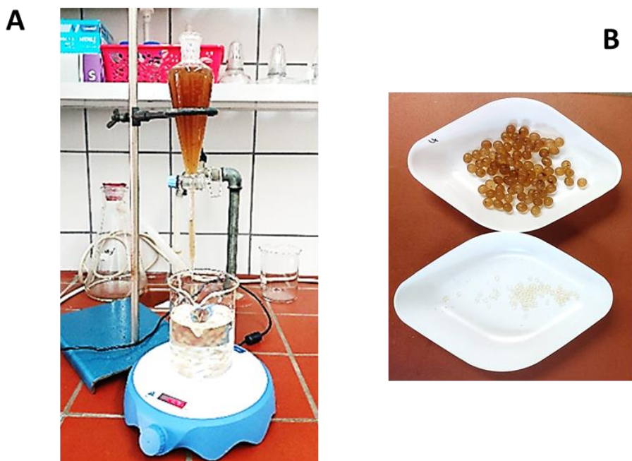
Slika 5. Aparatura za provođenje postupka imobilizacije (A) i izgled dobivenih mikrosfera biosorbensa prije i nakon sušenja (B).
