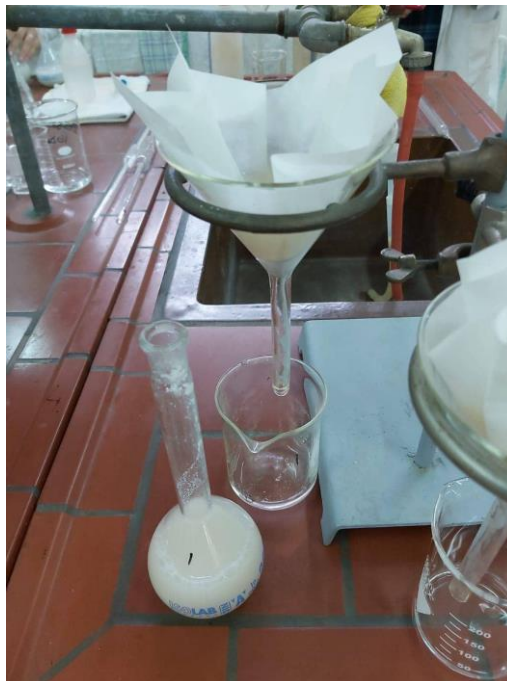
Slika 13. Postupak filtracije kod proizvodnje filtrata F1 (Izvor: autor)
