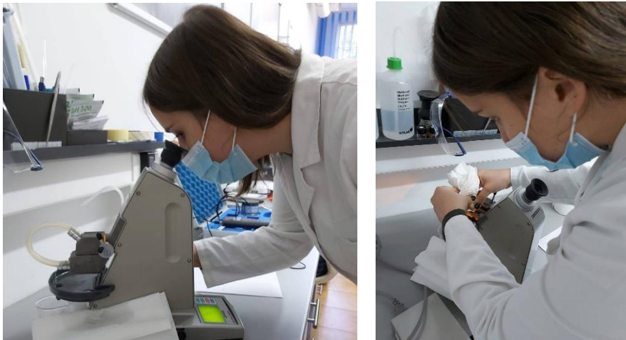
Slika 12. Određivanje topljive suhe tvari (Izvor: autor)
