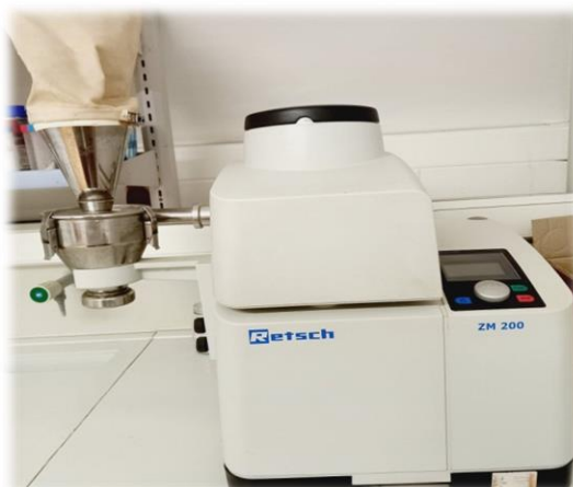
Slika 2. Ultracentrifugalni mlin Retsch ZM200
