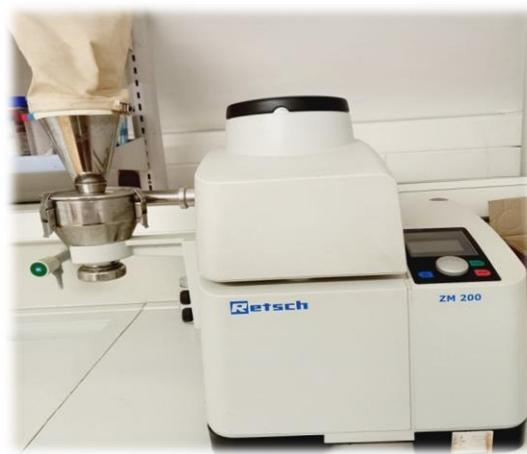
**Slika 2.** Ultracentrifugalni mlin Retsch ZM200
