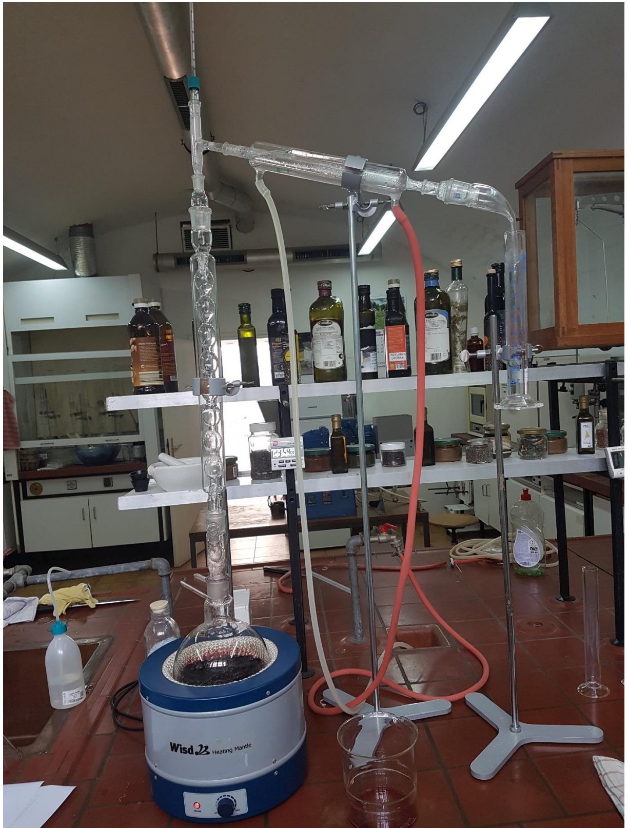
Slika 14. Laboratorijski uređaj za destilaciju (Izvor: Autor)
