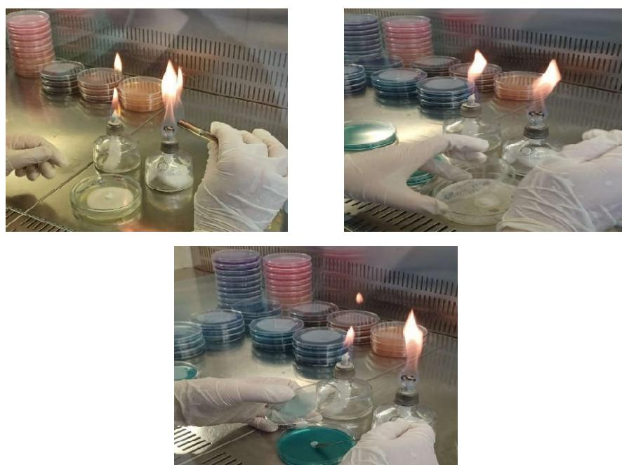
Slika 8 Nacjepljivanje podloge diskom gljivama bijelog truljenja
