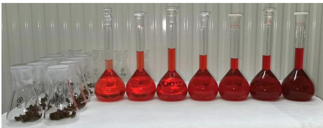
Slika 7. Biosorbens i otopine bojila za ispitivanje utjecaja početne koncentracije bojila.
