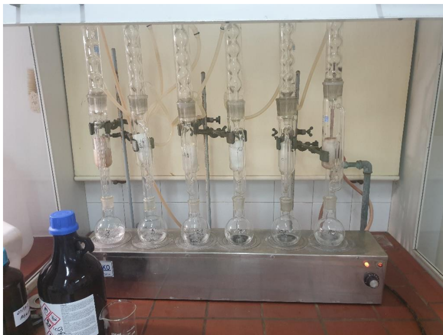
Slika 7 Metoda ekstrakcije ulja po Soxhlet-u
