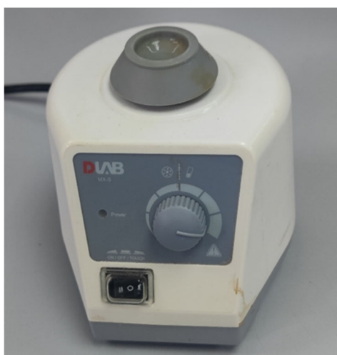
Slika 8 Vorteks (Vortex MX-S, DLAB Scientific, Kina)
