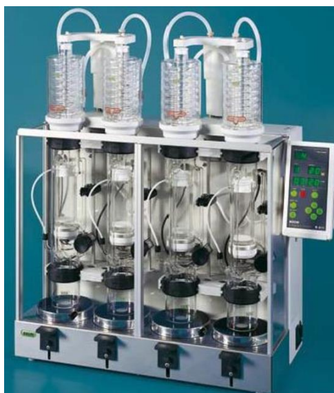
Slika 12. Automatiziran ekstrakcijski sustav po Soxletu B-811 LSV (Katalog opreme Prehrambeno-tehnološkog fakulteta Osijek, 2022.)
