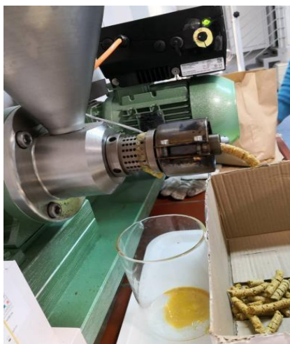
Slika 8 Preša i dijelovi preše s motorom i glavom za prešanje (Izvor: autor)
