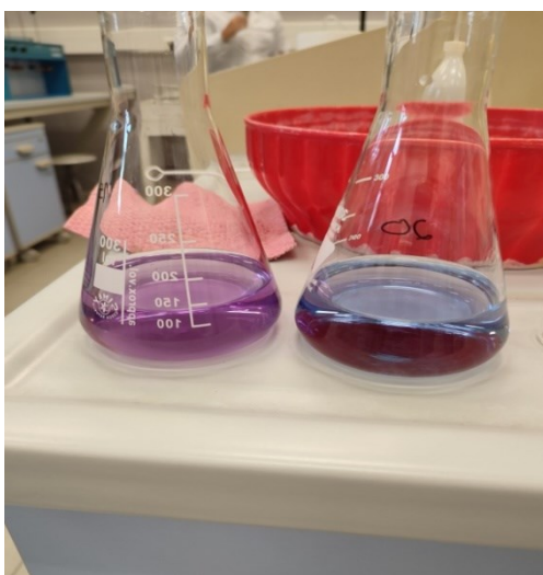
Slika 6. Promjena boje nakon titracije
