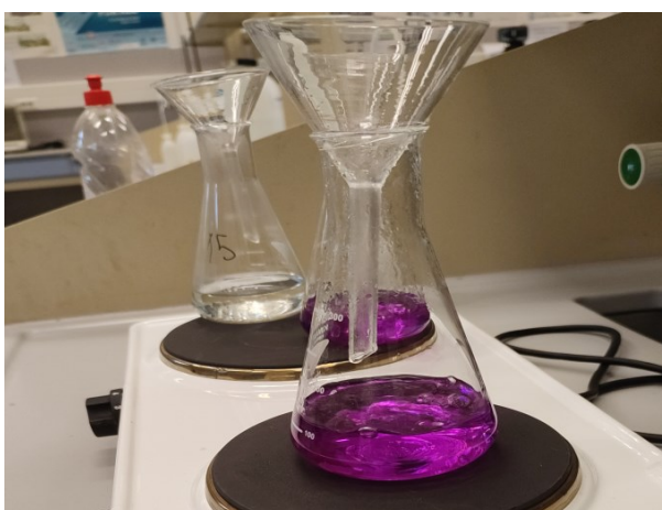
Slika 7. Vrenje uzorka s otopinom KMnO_4
