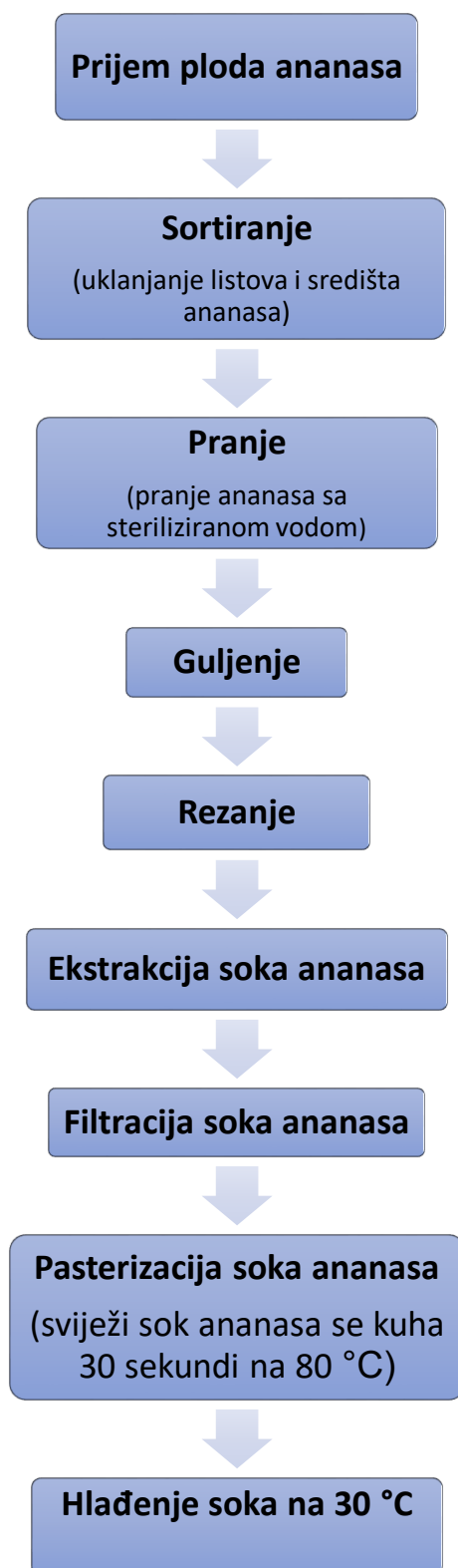
Slika 10 Dijagram tehnološkog postupka proizvodnje soka ananasa (izvor: Khalid, 2016)
