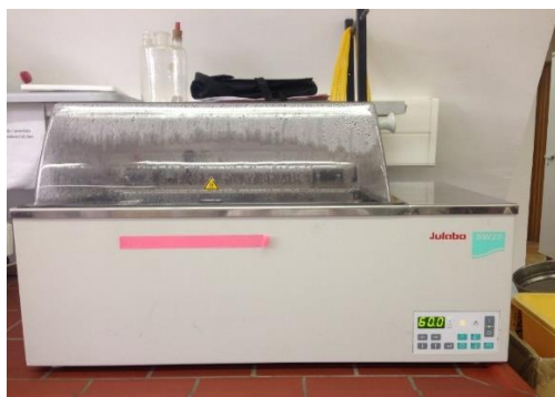
Slika 8 Vodena kupelj s tresilicom Julabo SW 23
