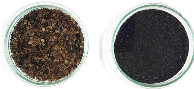
Slika 7. Heljdine ljuskice prije pirolize i aktivni ugljen dobiven pirolizom.
