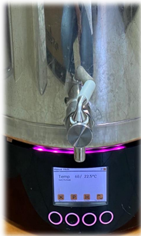
Slika 5: Prikaz kontrole temperature za vrijeme ukomljavaanja (izvor: privatna arhiva)
