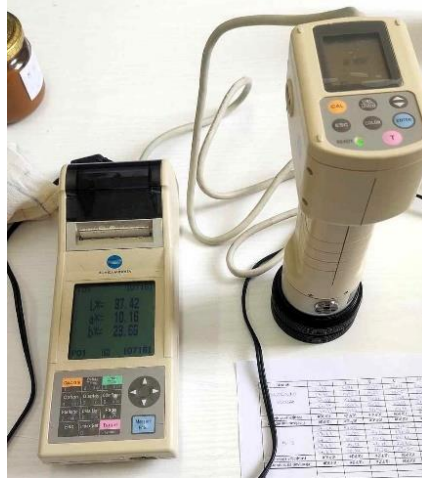
Slika 14. Određivanje boje kromametrom
