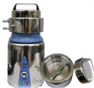
Slika 9 Uređaj za usitnjavanje uzorka SM-4500, mrc Sample mill (Katalog opreme Prehrambeno-tehnološkog fakulteta Osijek, 2022)
