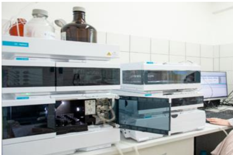
Slika 16 Visoko djelotvoran tekućinski kromatograf s detektorom s nizom dioda (Agilent Technologies 1260 Infinity, SAD) (Izvor: Stela Jokić)
